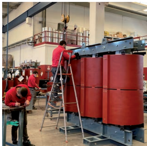
Сухий трансформатор з литою ізоляцією серії Ecodesign потужністю 5500 кВА — 10,5–15,75 кВ — Dyn11
