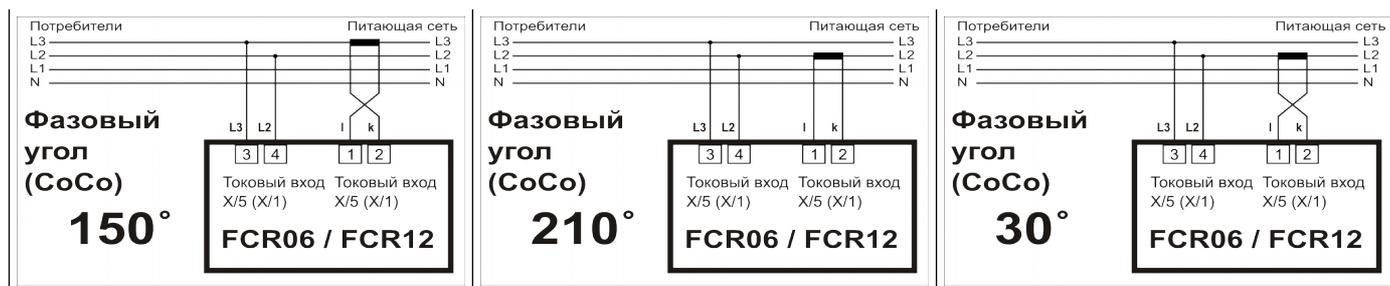
Таблица 6: Выставление фазового смещения для питающего и измеряемого напряжения 400 В AC
